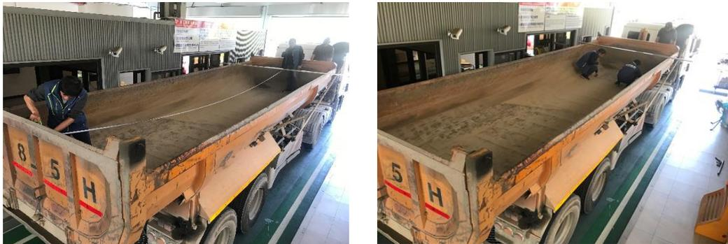
圖1：檢驗人員量測砂石車內容積
